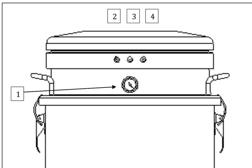
1. Manomètre : signale le colmatage du filtre
