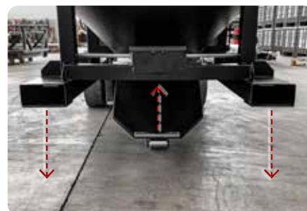
Sistema di chiusura portello a pressione sul pavimento
