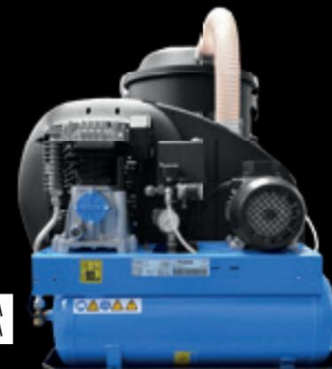
IL SISTEMA SP PERMETTE DI MANTENERE IL FILTRO PULITO AUTOMATICAMENTE SENZA ARRESTARE L'ASPIRAZIONE. OGNI FILTRO VIENE PULITO PERIODICAMENTE DA UN GETTO D'ARIA AD ALTA PRESSIONE (6 BAR)
