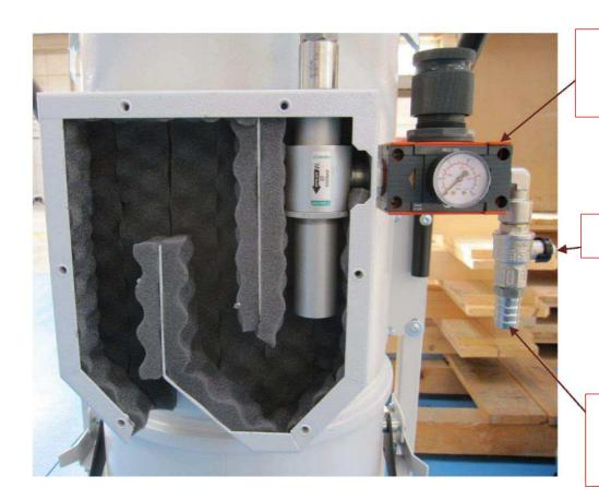
RÉGULATEUR DE PRESSION AVEC MANOMÈTRE
