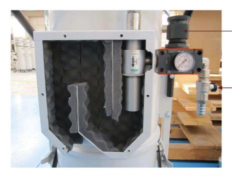
FILTRE RÉGULATEUR FLUX D'AIR COMPRIMÉ
